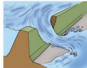
水が増え、水の力に堤防が耐えられなくなり、堤防の一部が崩れ始めます。
